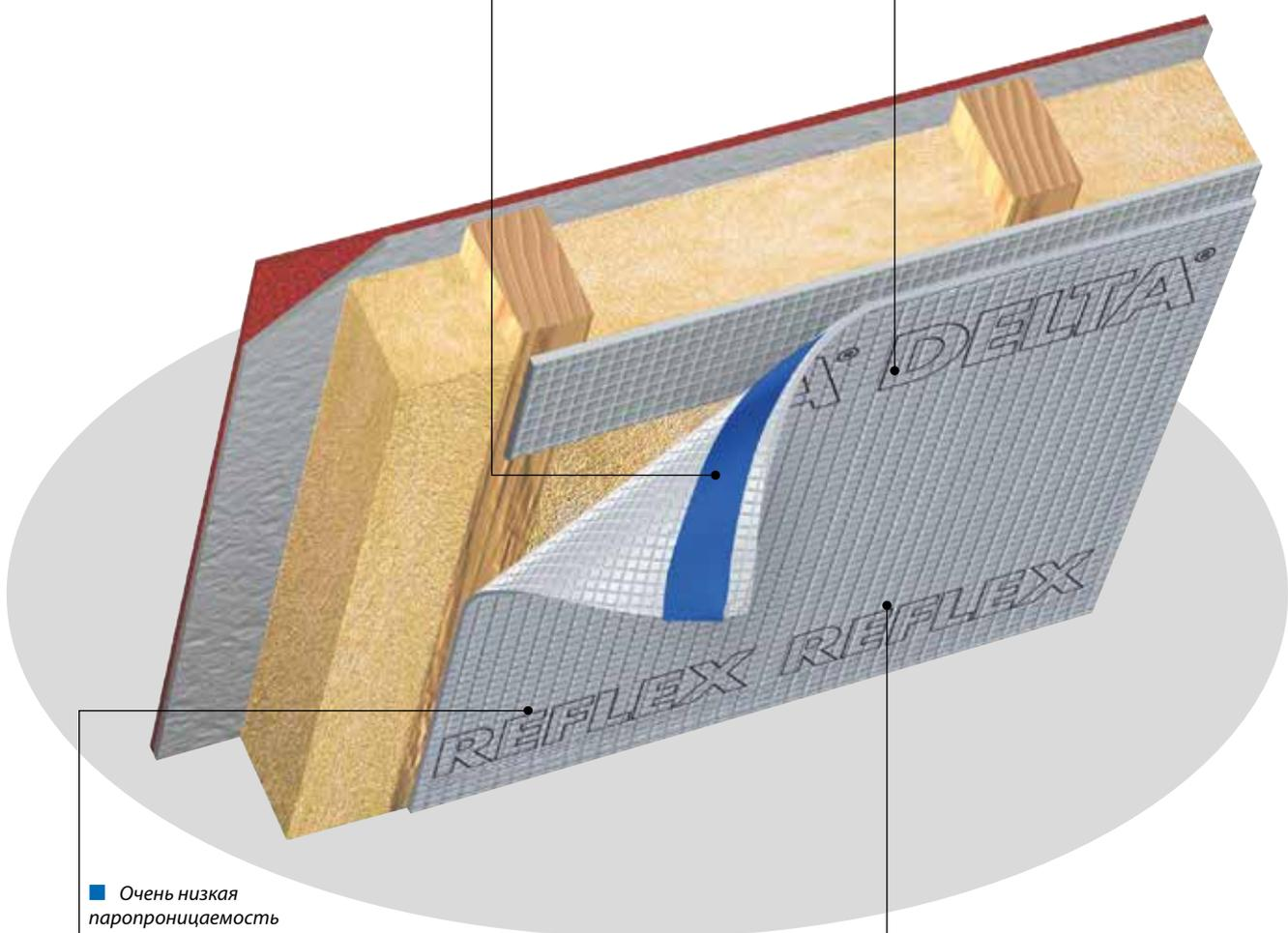
■ Очень низкая паропроницаемость ( $S_d > 150 \text{ м}$ ) гарантирует отсутствие конденсата в конструкции крыши. Утеплитель и стропила остаются сухими даже зимой.
